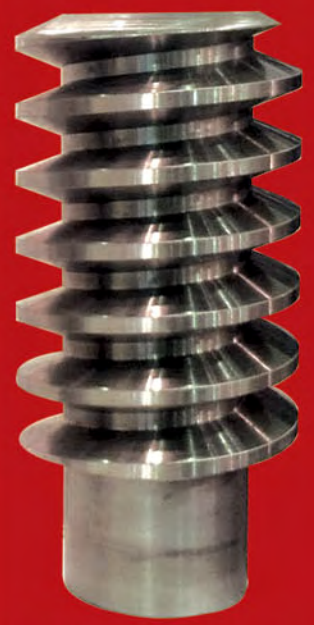
Ø 200 16 MODÜL SONSUZ VİDA Ø 200 16 MODULE WORM SCREW
